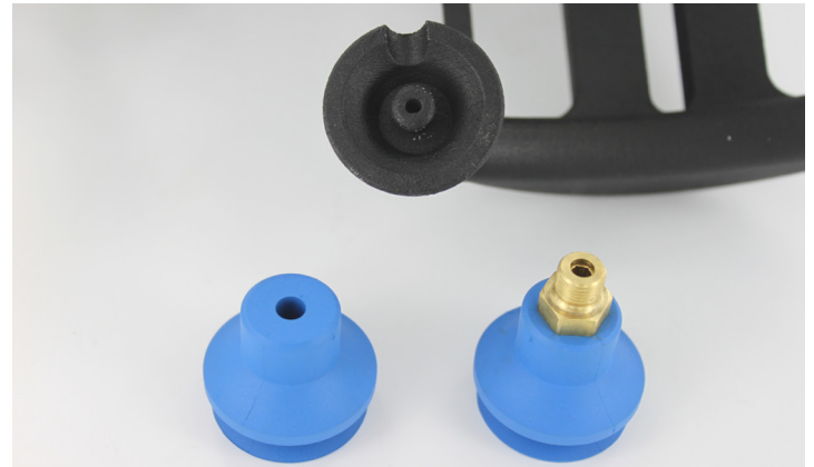
Bild 4: Vergleich von Vakuumsaugern mit und ohne Adapter vor der integrierten Saugernanbindung in der Roboterhand
