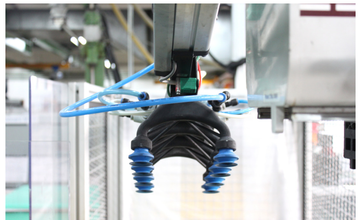
Bild 13: der Polyamid-Leichtbau sticht optisch aus den aluminiumgeprägten Roboterhänden hervor
