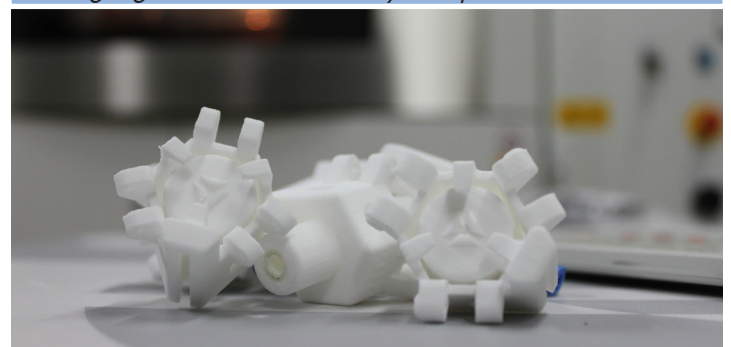
Bild 24: Innengreifer IGP mit integriertem Antriebsbalg nach der Entnahme aus der PA-Forming Anlage
