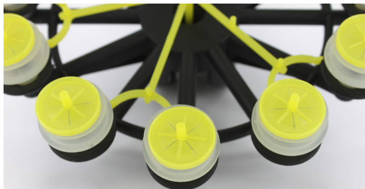
Bild 1: Leichtbau Roboterhand aus Polyamid mit kleinen Filtersieben
